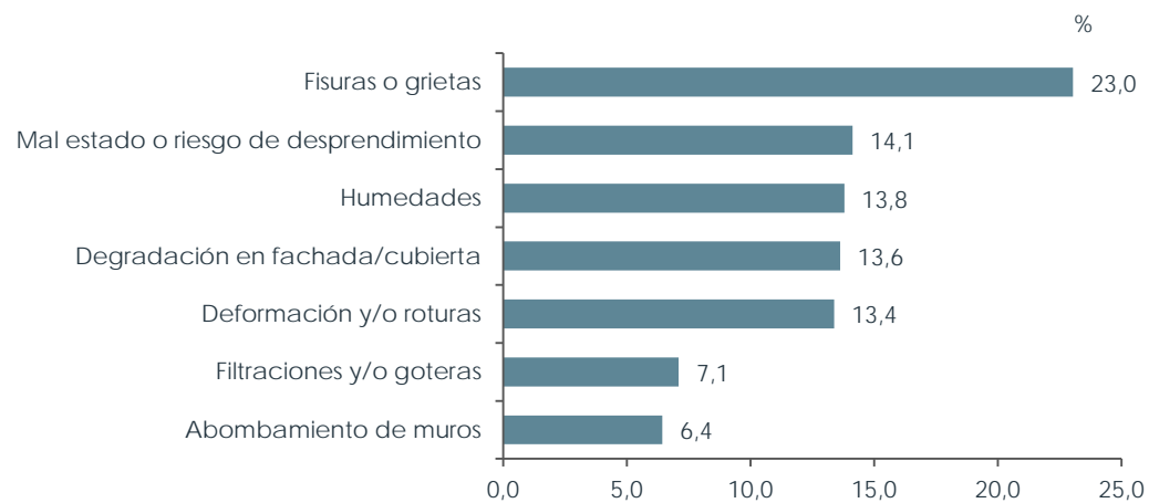
Gráfico 4.16 Principales deficiencias de los edificios calificados como “no aptos” en los IEE realizados en Navarra
