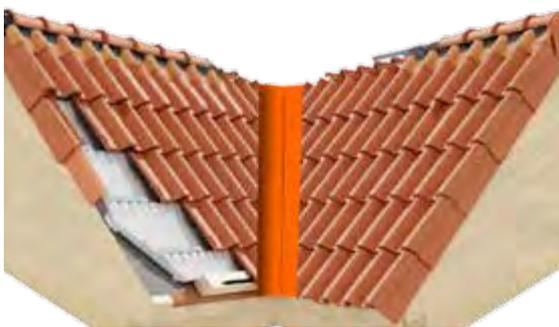
Fijación de limahoya metálica mediante tornillo
