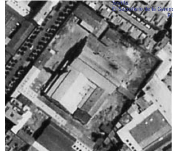
**1969:** Exenta la mitad de la longitud del muro de acceso de construcciones auxiliares. Se ha prolongado la cubierta de la nave 2 cobijando el espacio vacante entre ésta y la nave 3. Se mantiene la nave en L de la esquina oeste.
