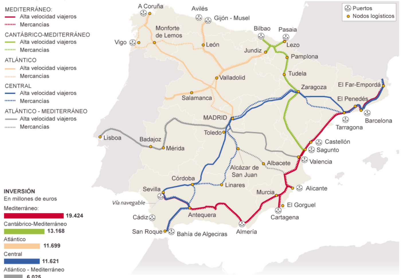
Red de Transporte Europea: Corredores Ferroviarios
