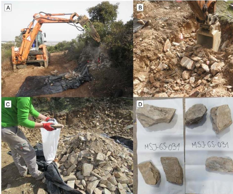
Figura 5-3. Secuencia del muestreo realizado en trinchera A) Máquina picando la zona a muestrear. B) Recolección de los bloques producidos, C) Selección de muestras in situ, D) Etiquetado y embolsado.
