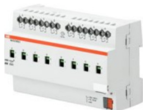
Figura 6. Actuador 8 canales 16 A SA/S 8.16.5.1, para el control de los servicios de pago de las habitaciones (electrodomésticos).
