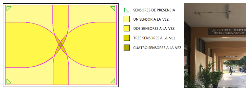
Figura 3. Area de trabajo de los sensores de movimiento en a) aula; b) pasillo exterior.
