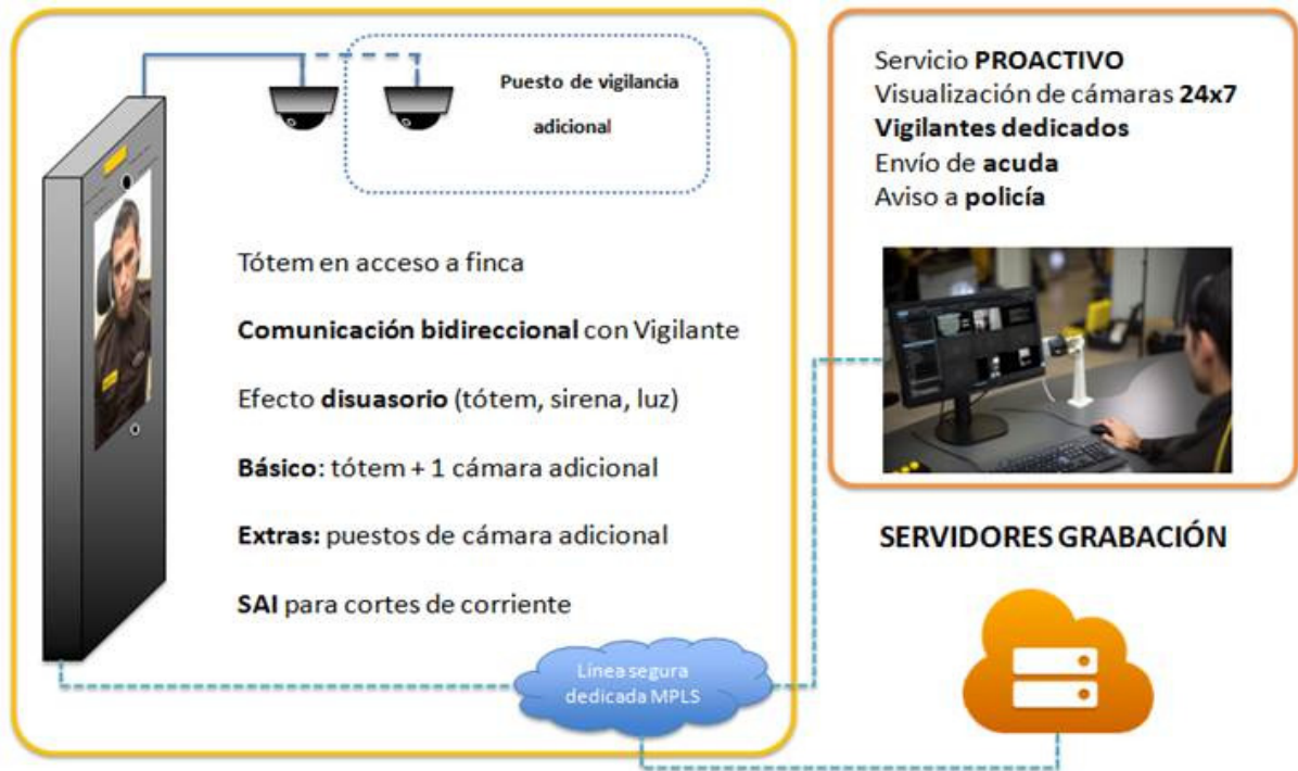
Figura 4. Componentes del tótem de Prosegur Ojo de Halcón.
